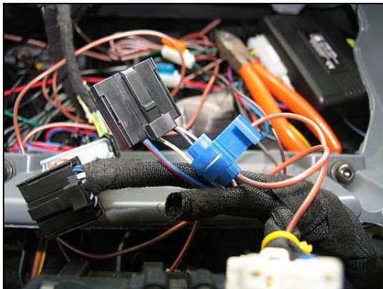
Abbildung 13: Anschluss Hupe: schwarzer Stecker-schwarzes Kabel
